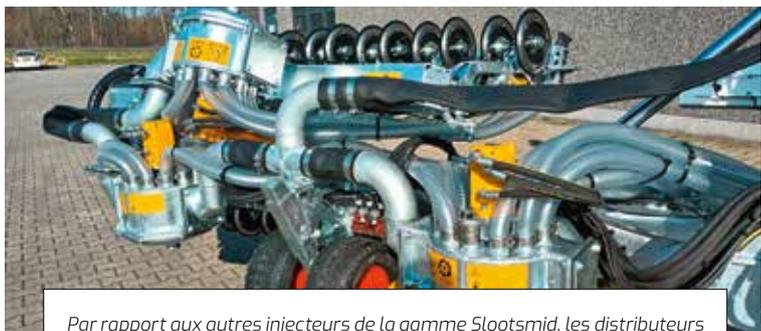
Par rapport aux autres injecteurs de la gamme Sloodsmid, les distributeurs du SGWM-PB sont positionnés à l'envers et légèrement plus bas, afin de faciliter leur interconnexion et de maintenir une pression homogène d'un bout à l'autre de la ligne.
