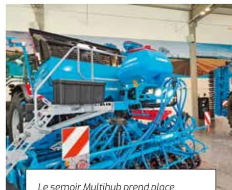
Le semoir Multihub prend place à l'arrière du combiné. Son contenu peut, au choix, être épandu sur le sol grâce à des éclateurs ou incorporé avec la semence.
