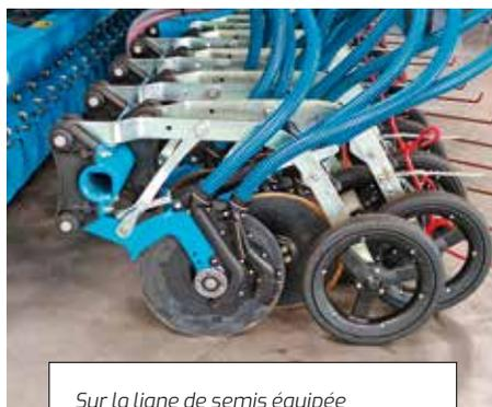
Sur la ligne de semis équipée du Double Shot, la deuxième descente s'ajuste pour écarter plus ou moins les deux produits, semences et/ou engrais.
