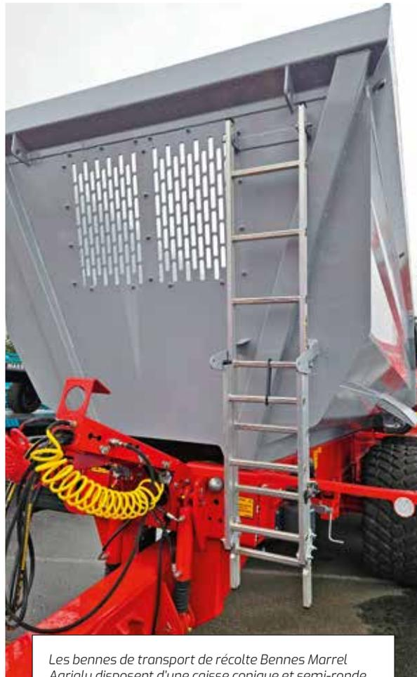
Les bennes de transport de récolte Benne Marrel Agrialu disposent d'une caisse conique et semi-ronde qui facilite leur vidage.
