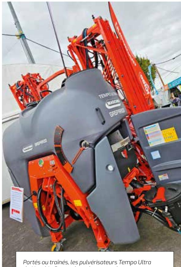
Portés ou traînés, les pulvérisateurs Tempo Ultra de Maschio Gaspardo embarquent des cuves d'une capacité maximum de 6 500 litres.
