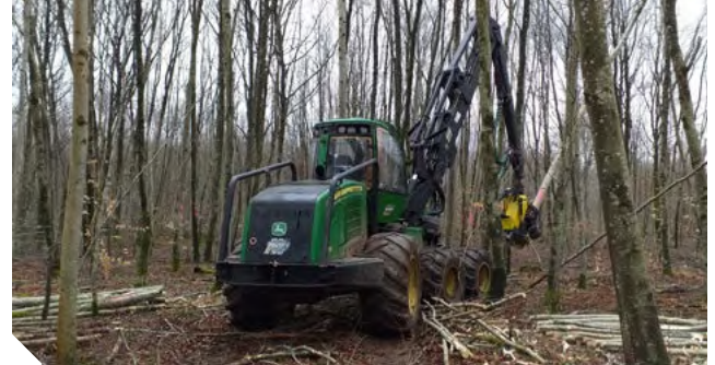
Porte-outil 6x6 de moyenne capacité* : puissance moteur de 197 ch, grue de 9,70 m de portée, couple de levage 165 kN.m. Machine adaptée aux premières éclaircies feuillues
