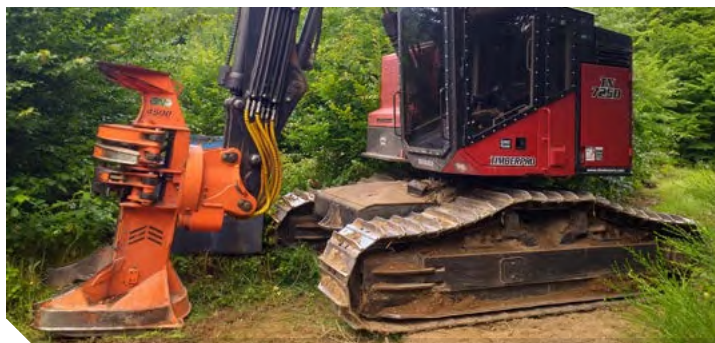
Porte-outil spécifique forestier de 25 t, l'ensemble étant aussi appelé feller-buncher
