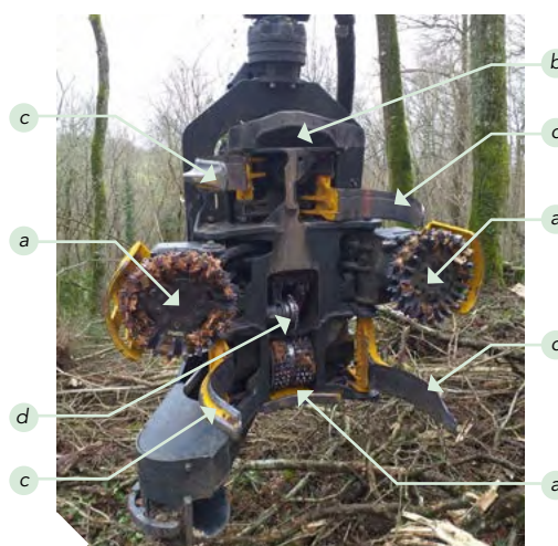
Un exemple de tête de bûcheronnage à 3 rouleaux d'entraînement (a), 2 couteaux fixes (b) et 4 couteaux mobiles (c). Roulette de mesure (d)
