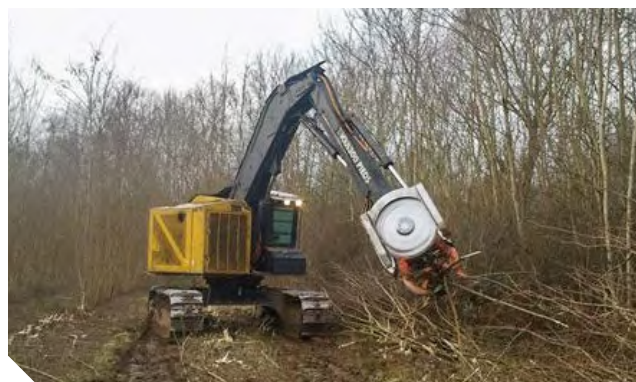
Tête à disque équipée de la fonction rotation facilitant la dépose du bois
