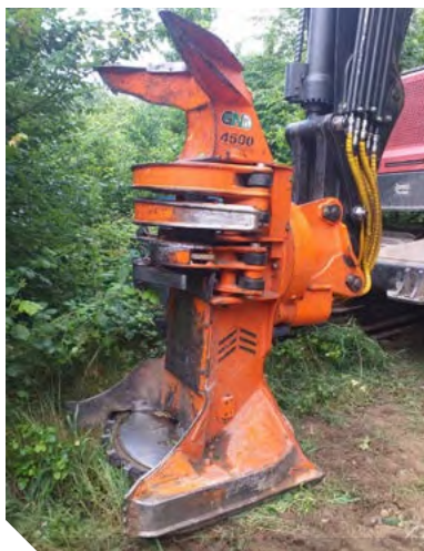
Tête à disque avec des dents à pointe de carbure munie d'un bras d'accumulation en plus des 2 bras du grappin
