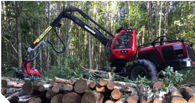
Porte-outil 6x6 de grande capacité* : puissance moteur de 258 ch, grue de 10 m de portée et couple de levage 230 kN.m. Machine polyvalente pour la récolte de bois moyens occasionnellement de petits bois et de gros bois
