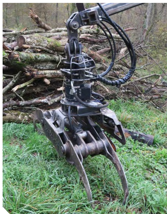
Un plus: le peson, fixé à l'extrémité de la grue, avant le grappin, et qui est équipé d'un système de transmission des données. Il présente l'avantage de pouvoir connaître instantanément les quantités de bois débardés.
