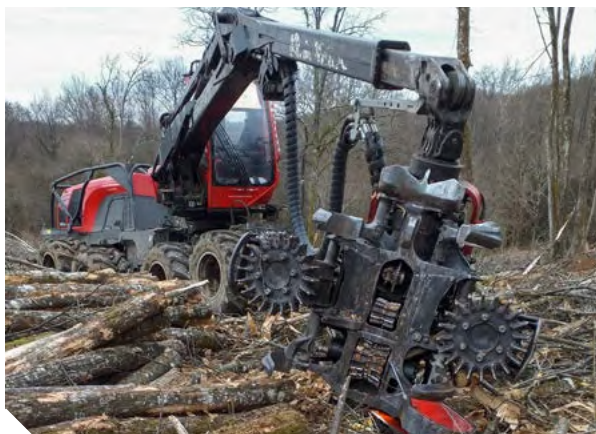
Exemple de tête à 4 rouleaux (capacité de coupe 65 cm) montée sur un porte-outil de 231 ch
