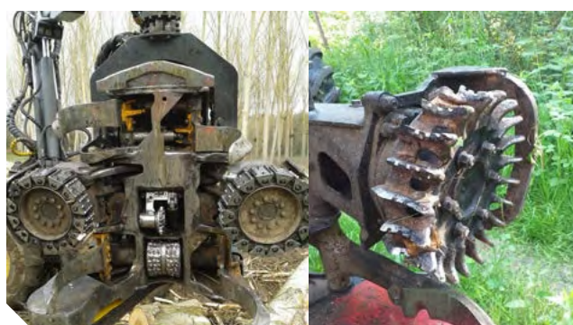
Exemple de rouleaux d'entraînement avec des petits picots sur barrettes flexibles sur caoutchouc pour la récolte de peupliers (à gauche) et de rouleaux avec une très bonne adhérence et une capacité autonettoyante appréciée en feuillus (à droite)
