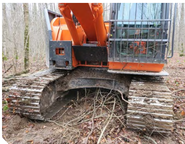
Pelle hydraulique de 14 tonnes équipée en chenilles métalliques de 600 mm de large
