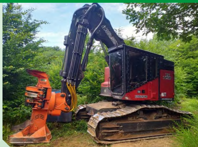
Feller-buncher de 25 tonnes, grue de portée de 7,60 m
