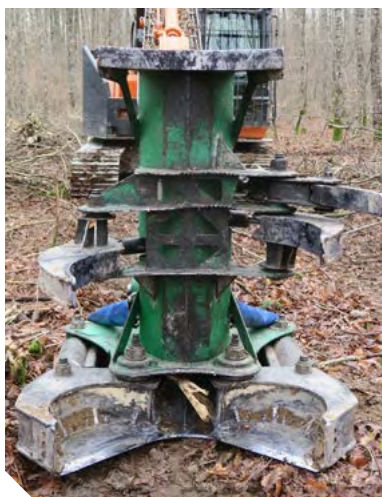
Cisaille forestière à 2 lames avec un bras d'accumulation en plus des 2 bras du grappin
