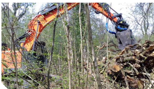
Cisaille équipée de la fonction rotation facilitant la dépose du bois
