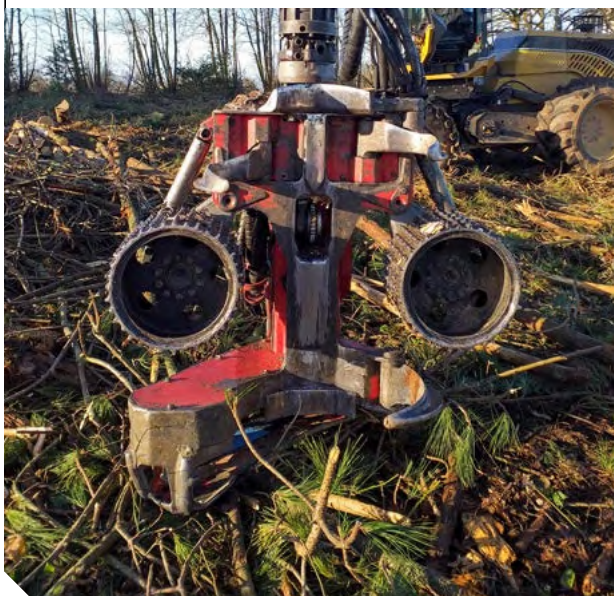
Tête de bûcheronnage compacte (900 kg avec rotator et 1,48 m de haut) à 2 rouleaux, 1 couteau fixe et 3 couteaux mobiles
