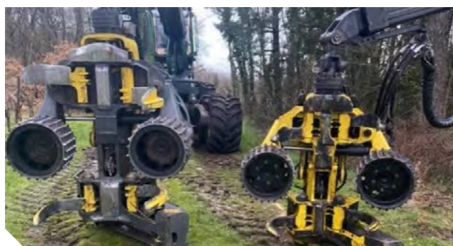
Exemple de têtes de bûcheronnage à 2 rouleaux d'entraînement à serrage parallèles : à droite une tête pour les premières éclaircies (diamètre d'abattage max. 520 mm), compacte (largeur bras ouverts 1 150 mm) et légère (moins de 800 kg). À gauche, une grosse tête (plus de 1 900 kg largeur bras ouvert 1 970 mm) adaptée aux bois moyens et gros bois (diamètre d'abattage max. 750 mm)
