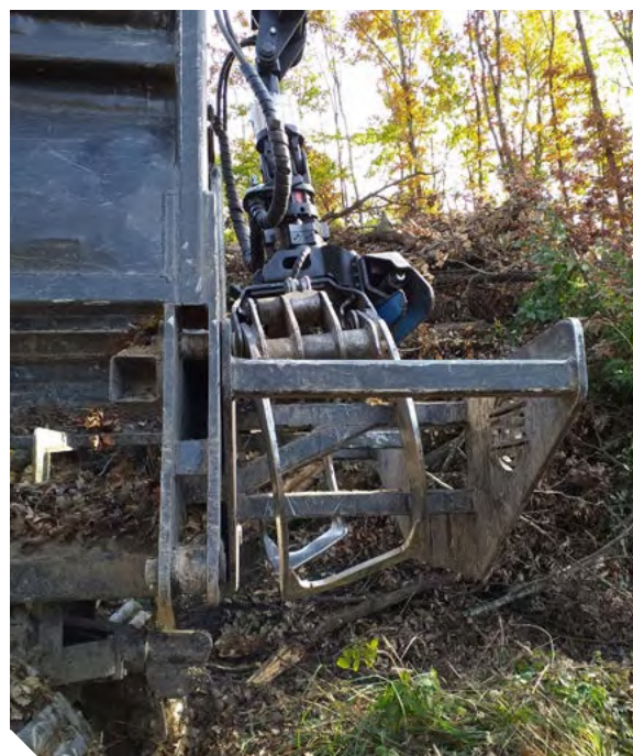
Un grappin-scie à bras asymétriques permet de mieux positionner la tête le long du fût pour couper des grosses branches
