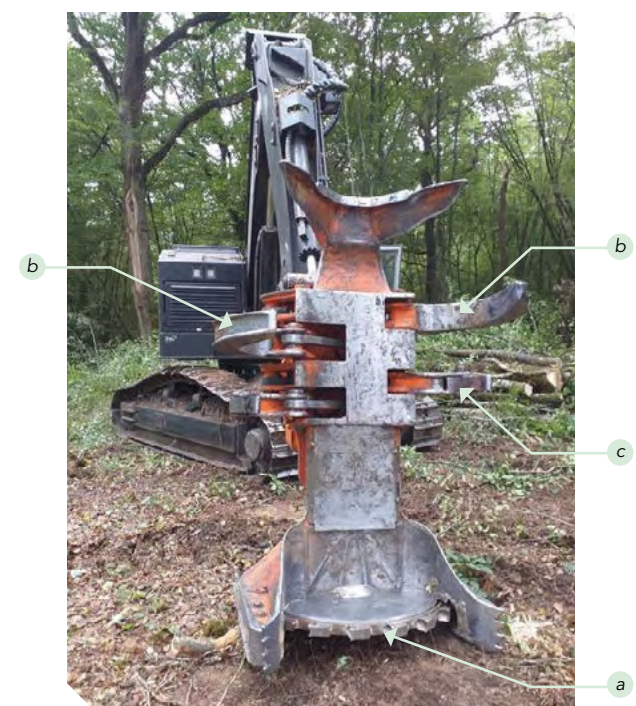
(a) disque, (b) 2 bras de préhension faisant fonction de grappin, (c) un bras accumulateur
