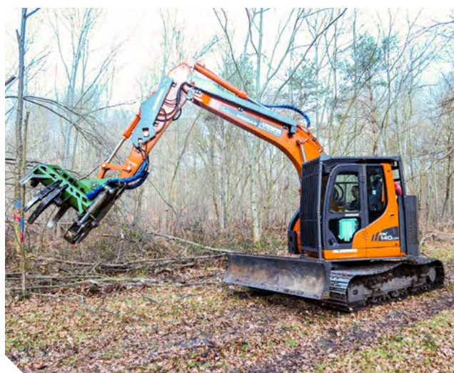
Pelle hydraulique de 14 tonnes à faible déport arrière, équipée de protections forestières au niveau de la tourelle et du bras et lame à l'avant.
