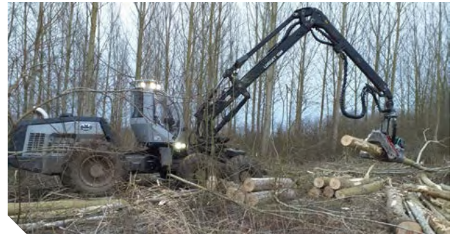
Porte-outil 6x6 de très grande capacité* : puissance moteur de 300 ch, grue de 9,70 m de portée et couple de levage 290 kN.m. Machine adaptée à la récolte des gros peupliers
