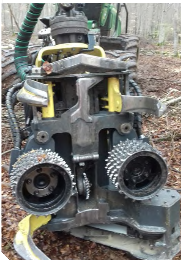
Tête de bûcheronnage compacte (850 kg avec rotator et 1,30 m de haut) à 2 rouleaux, 1 couteau fixe et 3 couteaux mobiles
