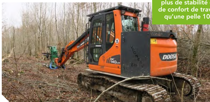
Pelle hydraulique de 14 t avec protections forestières
