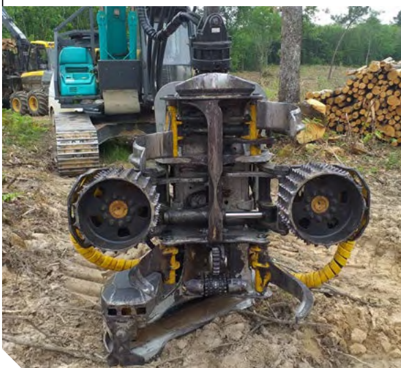
Exemple de tête à 2 rouleaux (capacité de coupe 68 cm) montée sur une pelle hydraulique de 18 t
