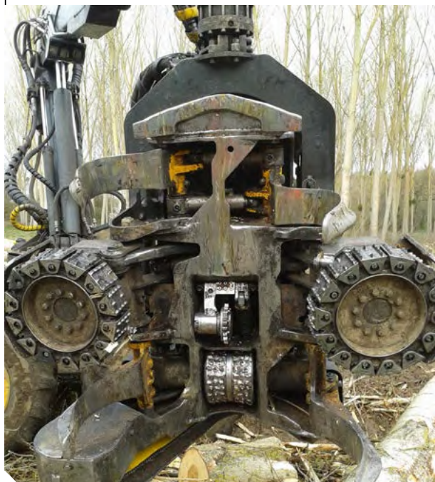
Exemple de tête de bûcheronnage munie de 2 rouleaux d'entraînement avec des petits picots sur barrettes flexibles sur caoutchouc
