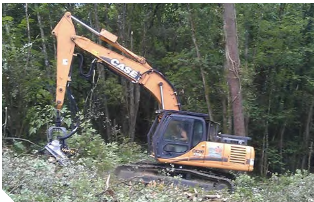
Pelle hydraulique de 21 tonnes dans une coupe de renouvellement d'un taillis de châtaignier
